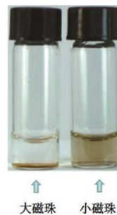
图 2 粒径大小不同的磁珠在同一磁场中分离速度的差异
